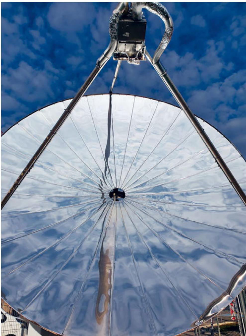
Prototyp eines künstlichen Baumes: Der Parabolspiegel fokussiert die Sonnenstrahlung auf das Gerät, in dem Wasser in Wasserstoff und Sauerstoff gespalten wird. Foto: LRESE@EPFL and Sohhytec
