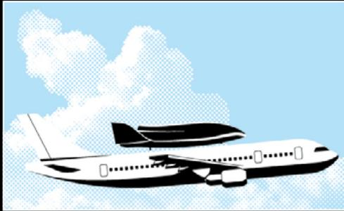
**1** Swiss Space System (S3) entwickelt ein Raumschiff, das kleine Satelliten in den Orbit bringen kann. Vom Boden aus ferngesteuert löst sich das Raumschiff mit dem Namen Soar in 10 000 Meter Höhe vom Rücken des Airbus. Die ersten kommerziellen Flüge sind für 2018 vorgesehen. Das 2012 in Payerne (VD) gegründete Unternehmen vereinigt in seinem Flugobjekt Technologien von rund zwanzig internationalen Partnern. Der Börsengang ist für 2015 vorgesehen.
